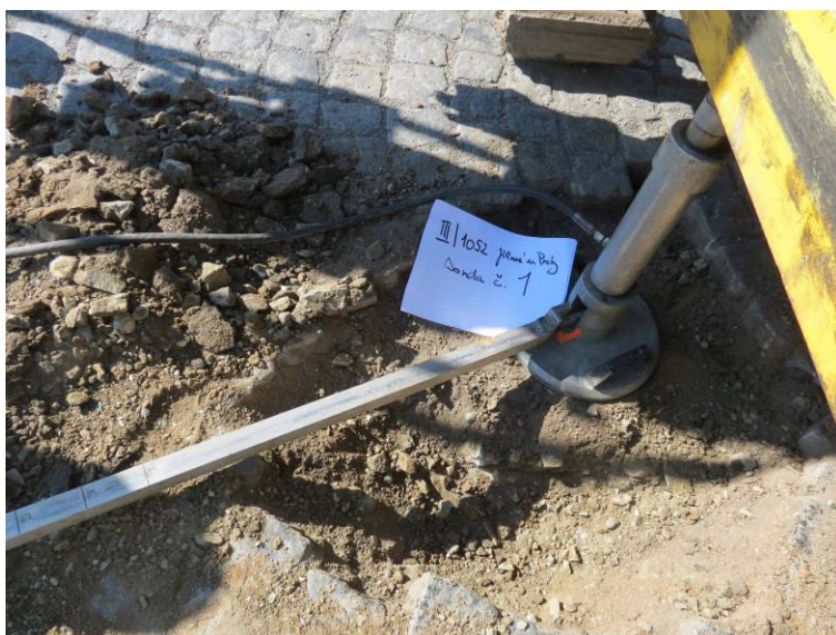
Sonda č.1 – konstrukční vrstva – statická zatěžovací zkouška
