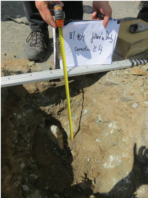
Sonda č.4 – celková hloubka sondy a štět v zemní pláni
