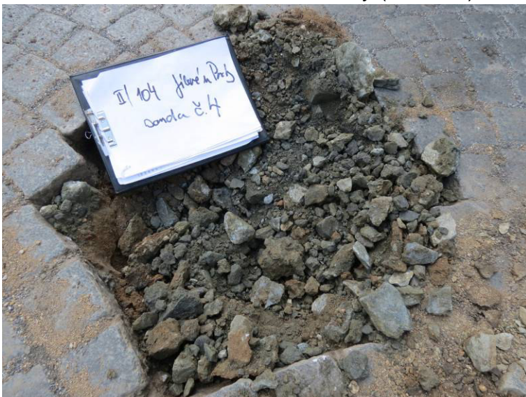
Sonda č.4 materiál konstrukční vrstvy (ŠD 0/63)
