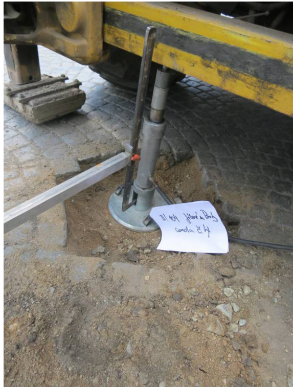
konstrukční vrstva –zatěžovací zkouška
