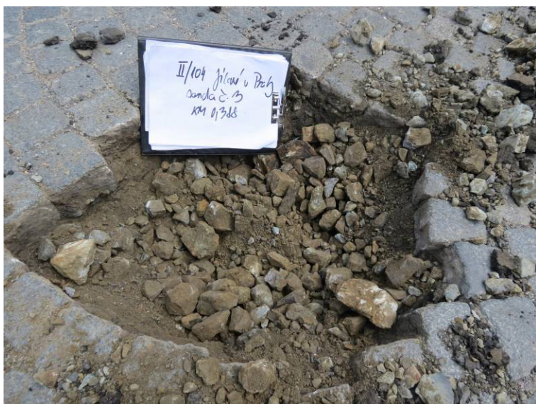
Sonda č.3 – materiál konstrukční vrstvy (ŠD 0/125)
